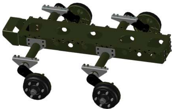
Nosný rám s nezávislým zavěšením
